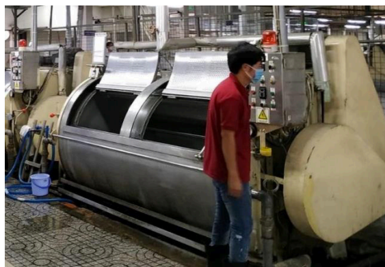
Hình 5. Máy giặt cấp nước thủ công tại một nhà máy
