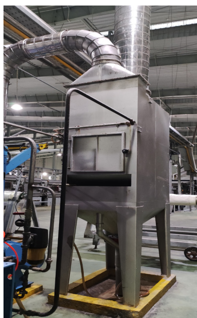
Hình 10. Tái sử dụng nước giải nhiệt cho dập bụi của máy đốt lông
