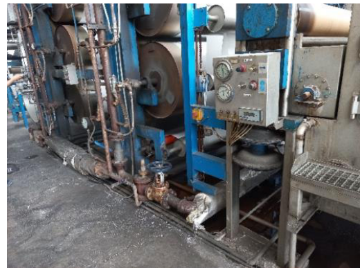
Hình 15. Thu hồi nước ngưng từ các trống sấy
