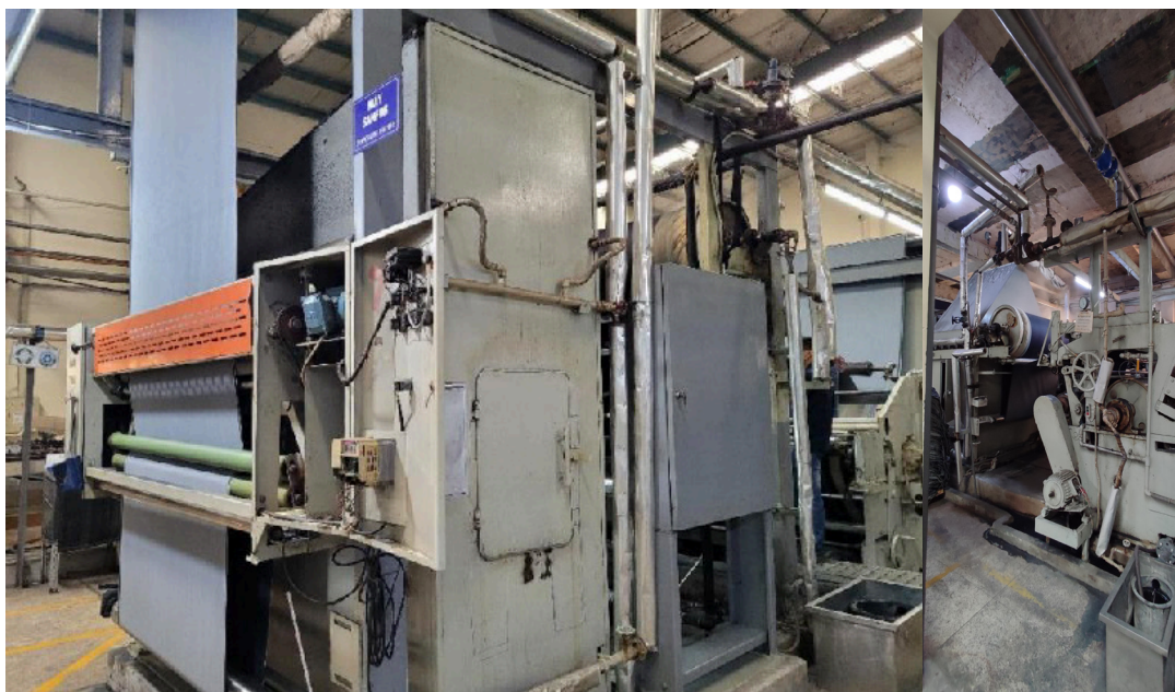
Hình 9. Nước sau giải nhiệt máy Sanfor được lọc trước khi qua tháp giải nhiệt và tuần hoàn lại giải nhiệt cho máy
